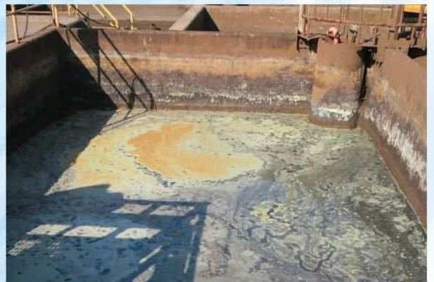
●工业废物中间体处理(污泥固化·不溶解)
